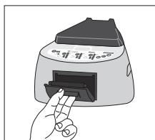
1.Para reemplazar el rollo de papel, tire de la manija ubicada en la puerta de la impresora. Abra la tapa de la impresora y retire el rollo usado.
